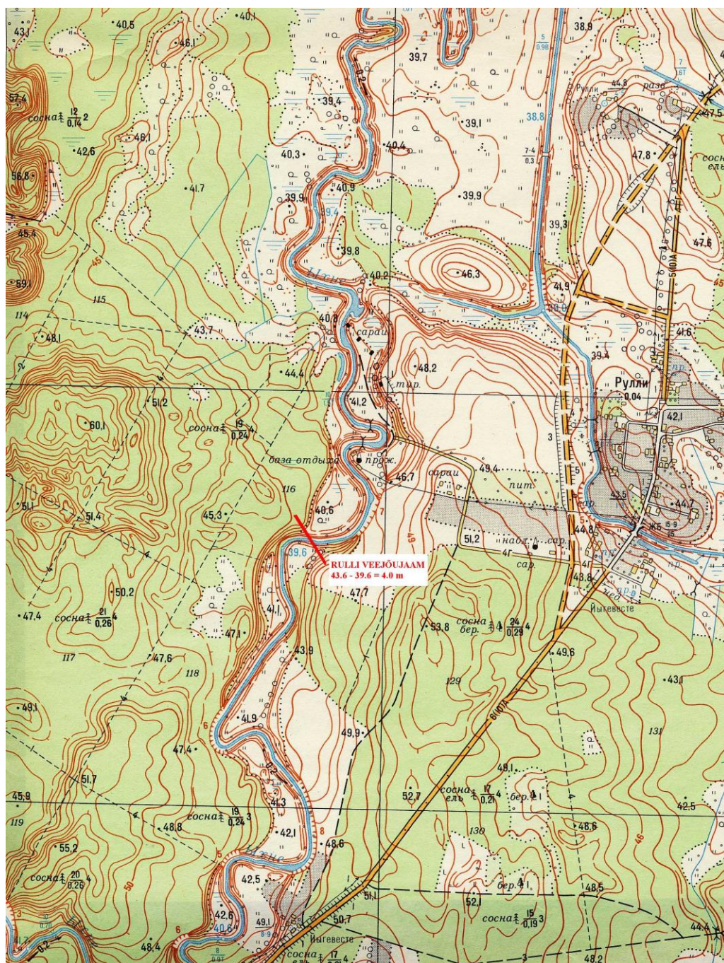
Joon 2.3.2.1. Õhne jõe suurima võimsusega veejõuam oleks Rulli profiilis (joonis 1:10 000), H = 4 m, Q = 200 kW. Paisjärv jääb ürgoru kallaste vahele, pindala 18,2 ha, maht umbes 460 000 m 3 , pikkus 4,5 km, paisjärv ulatub Tartu maanteeni, vt. joonis 3, mõõtkavas 1:10000 ja fotod.
